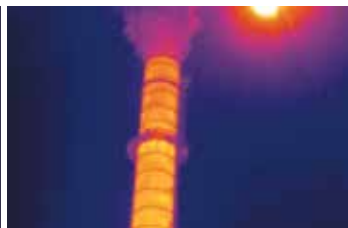
Inspection du matériau réfractaire d'une cheminée de four.
