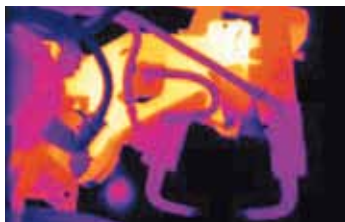
Point chaud sur un robot de soudage
