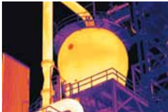
Inspection du matériau réfractaire d'un réacteur pétrochimique
